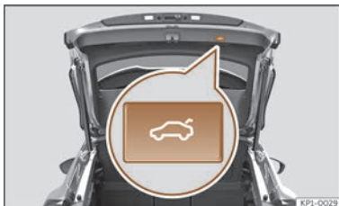
Abb. 82 Heckklappe: Taste zum Schließen der Heckklappe.
