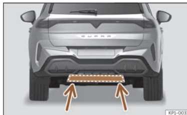
Abb. 85 Erfassungsbereich des unteren Sensors
