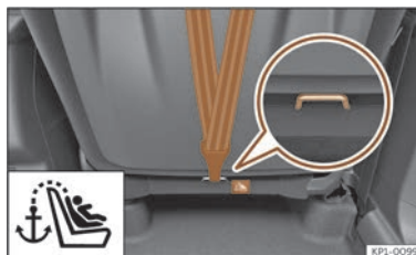
Abb. 44 Rückseite der Beifahrersitzlehne: Verankerung für den Top Tether Haltegurt (nicht in allen Märkten erhältlich).
