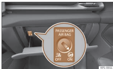
Abb. 30 Schlüsselschalter zum Ein- und Abschalten des Beifahrerairbags.
