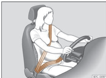
Abb. 26 Gurtbandverlauf bei schwangeren Frauen.
