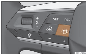
Abb. 122 Linke Seite des Multifunktionslenkads: Taste für die Fahrerassistenzsysteme (modellabhängig).
