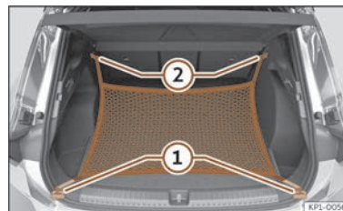
Abb. 191 Im Gepäckraum: Ösen ① und Haken ② zum Einhängen des Gepäckraumnetzes.
