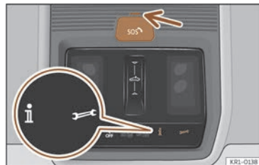
Abb. 49 In der Dachkonsole: Schalter für Sprachdienste.
