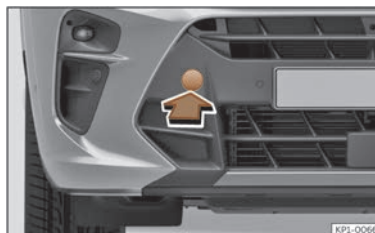
Abb. 211 Auf der rechten Seite des vorderen Stoßfängers: Abdeckung entfernen.
