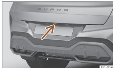
Abb. 128 Im Griff der Heckklappe: Einbauort der Kamera des Rückfahrasistenten.
