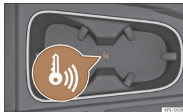
Abb. 115 In der Mittelkonsole: Notstart.
