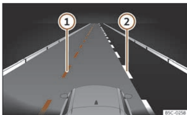
Abb. 140 Im Display des Kombi-Instruments: Anzeigen des Spurhalteassistenten.
