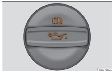
Abb. 230 Deckel der Motoröl-Einfüllöffnung im Motorraum.
