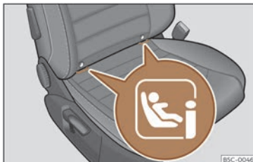
Abb. 41 Beifahrersitz: Einbauort der Halteösen i-Size.
