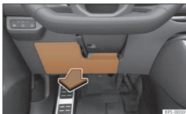
Abb. 215 Auf der Fahrerseite in der Instrumententafel: Abdeckung des Sicherungskastens.
