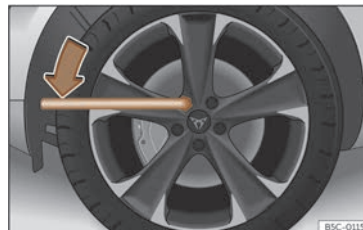
Abb. 241 Radwechsel: Radschrauben lockern
