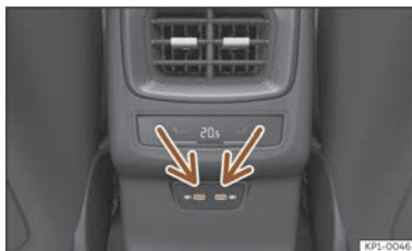
Abb. 174 Mittelkonsole hinten: USB-Anschlüsse mit Steckdosenfunktion.
