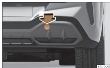
Abb. 213 Auf der rechten Seite des hinteren Stoßfängers: Abdeckung entfernen.
