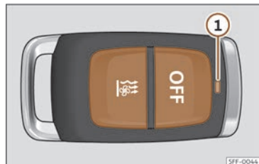
Abb. 113 Standheizung: mit Funkfernbedienung
