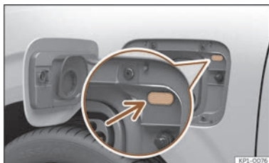
Abb. 61 Hinter der Batterieladeflappe: Ladevorgangsanzeige.
