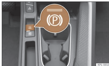
Abb. 147 Im unteren Bereich der Mittelkonsole: Taste für die elektronische Parkbremse.
