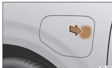
Abb. 59 Öffnung der Batterieladeklappe.
