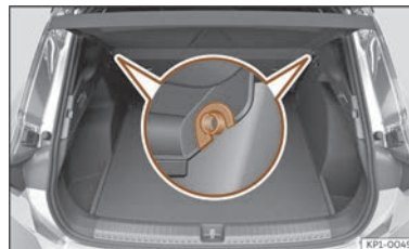
Abb. 182 Im Gepäckraum: Gepäckraumabdeckung aus- und einbauen.
