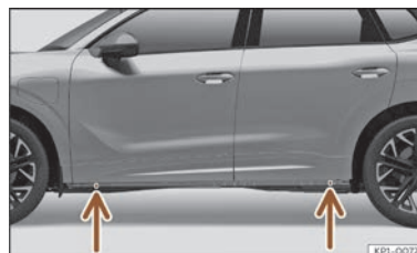
Abb. 242 Aufnahmepunkte für den Wagenheber.
