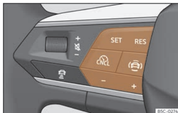
Abb. 130 Am Multifunktionslenkrad: Tasten zur Bedienung des Geschwindigkeitsbegrenzers.
