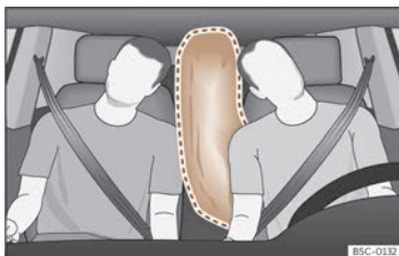
Abb. 33 Vollständig entfalteter Center-Airbag (Entfaltungsbereich)
