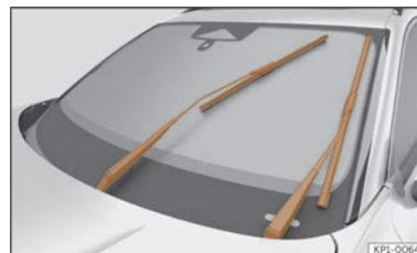
Abb. 205 Scheibenwischer in Servicestellung.
