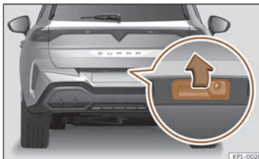
Abb. 81 Heckklappe: Öffnen von außen
