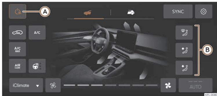
Abb. 110 Schematische Darstellung: Menü Klimatisierung.
