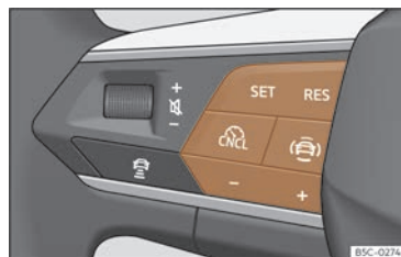
Abb. 129 Am Multifunktionslenkrad: Tasten zur Bedienung der Geschwindigkeitsregelanlage.
