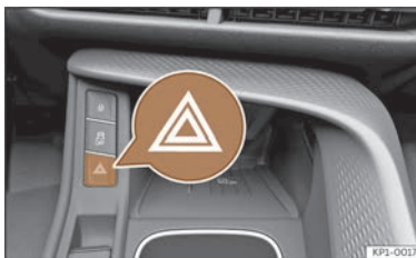
Abb. 48 Mittelkonsole: Schalter für die Warnblinkanlage.
