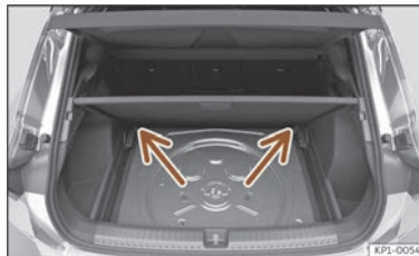
Abb. 187 Variabler Gepäckraumboden: geneigte Stellung.
