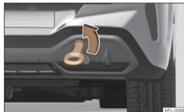
Abb. 214 Auf der rechten Seite des hinteren Stoßfängers: Eingeschraubte Abschleppöse.
