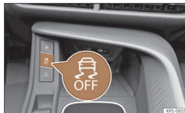
Abb. 121 Im unteren Bereich der Mittelkonsole: Taste zum Ein-/Ausschalten von ESC.
