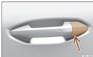
Abb. 77 Fahrertürgriff: verborgener Schließzylinder.
