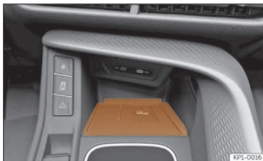
Abb. 180 In der Mittelkonsole: Aufnahme für die Mobiltelefonkopplung.
