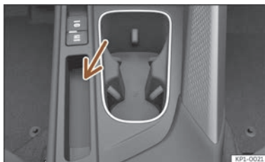
Abb. 69 Mittelkonsole: Aufnahme für den Fahrzeugschlüssel
