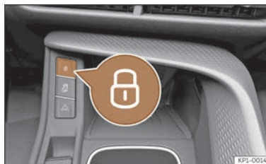
Abb. 76 Auf der Mittelkonsole: Zentralverriegelungstaster
