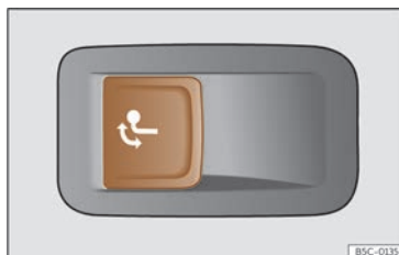
Abb. 196 Auf der linken Seite im Gepäckraum: Taste zur Entriegelung der Anhängerkupplung.
