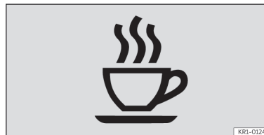
Abb. 8 Am Bildschirm des Kombi-Instruments: Symbol des Müdigkeitsmonitors.
