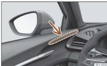
Abb. 143 Kontrollleuchte des Spurwechselassistenten.
