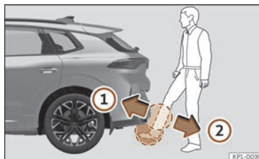
Abb. 84 Heckklappe mit sensorgesteuerter Öffnung (Easy Open).
