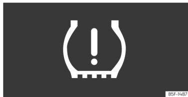
Abb. 244 Kombi-Instrument: Warnung Reifendruckverlust.
