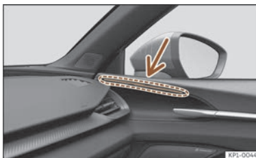
Abb. 144 Kontrollleuchte des Spurwechselassistenten.
