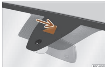
Abb. 125 Kamerasichtfenster des Spurhalteassistenten.
