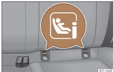
Abb. 40 Rückbank: Einbauort der Halteösen ISOFIX oder i-Size.
