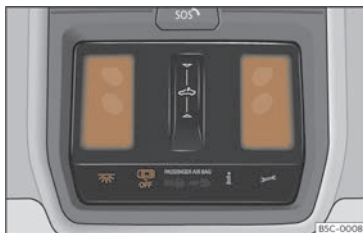
Abb. 103 Ausschnitt aus Dachhimmel: Innenbeleuchtung vorn.
