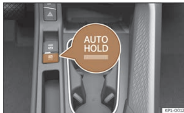
Abb. 148 Im unteren Bereich der Mittelkonsole: Funktionstaste Auto Hold.
