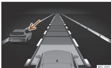
Abb. 134 Am Bildschirm des Kombi-Instruments: ACC aktiv, Fahrzeug auf der linken Seite erkannt.
