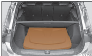
Abb. 184 Im Gepäckraum: Einsetzen der Gepäckraumabdeckung.
