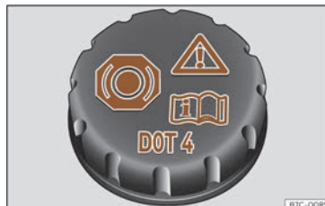
Abb. 224 Frontraum: Deckel des Bremsflüssigkeitsbehälters.
