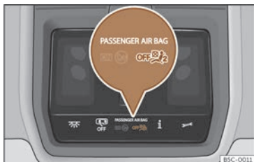
Abb. 31 In der Dachkonsole: Kontrollleuchte für Airbag Beifahrerseite aus.
