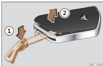
Abb. 71 Fahrzeugschlüssel: Abdeckung des Batteriefachs öffnen.
