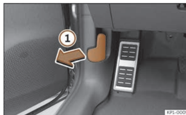
Abb. 219 Entriegelungshebel im Fahrerfußraum.
