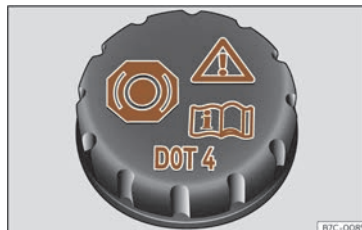
Abb. 231 Frontraum: Deckel des Bremsflüssigkeitsbehälters.
