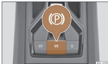
Abb. 154 Im unteren Bereich der Mittelkonsole: Taste für die elektronische Parkbremse.
