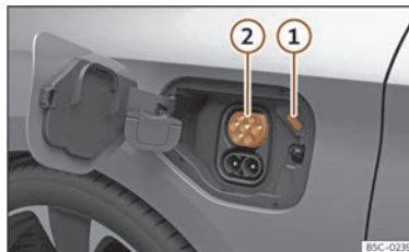
Abb. 60 Hinter der Batterieladeklappe vorn links: Ladedose
