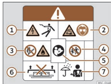
Abb. 56 Warnschild auf der Hochvoltbatterie.
