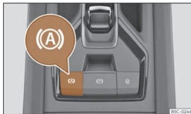
Abb. 155 Im unteren Bereich der Mittelkonsole: Funktionstaste Auto Hold.
