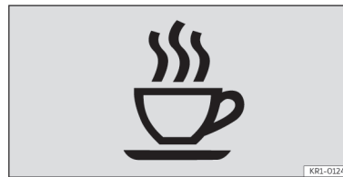
Abb. 7 Am Bildschirm des Kombi-Instruments: Symbol des Müdigkeitsmonitors.
