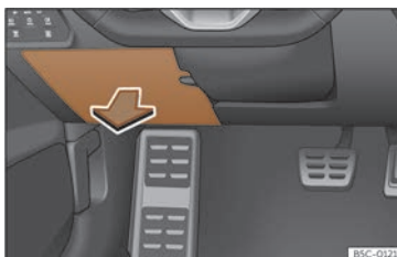
Abb. 223 Auf der Fahrerseite in der Instrumententafel: Abdeckung des Sicherungskastens.
