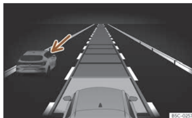
Abb. 141 Am Bildschirm des Kombi- Instruments: ACC aktiv, Fahrzeug auf der linken Seite erkannt.
