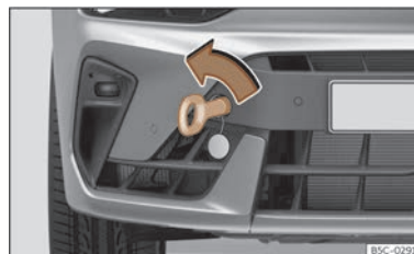
Abb. 220 Vorderer Stoßfänger rechts: Eingeschraubte Abschleppöse
