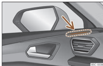
Abb. 150 Kontrollleuchte des Spurwechselassistenten.
