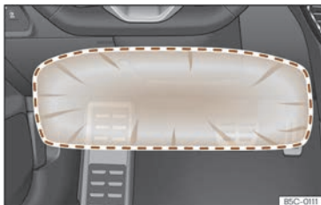
Abb. 36 Auf der Fahrerseite: Wirkungsbereich des Knieairbags.
