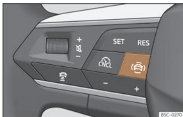
Abb. 129 Linke Seite des Multifunktionslenkads: Taste für die Fahrerassistenzsysteme (modellabhängig).
