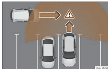
Abb. 165 Schematische Abbildung des Ausparkassistenten: Überwachter Bereich des ausparkenden Fahrzeugs.
