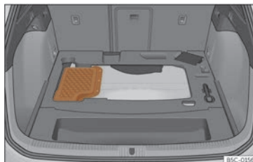
Abb. 238 Plug-in-Hybridfahrzeuge (PHEV): Einbauort der Batterie im Kofferraum
