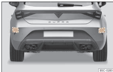
Abb. 133 Bereich hinter dem Fahrzeug: Bereiche der Radarsensoren.
