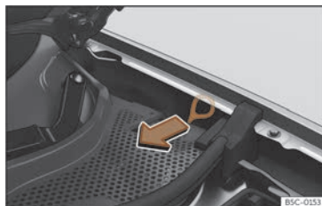
Abb. 65 Zwischen dem linken Kotflügel und dem Scharnier der Frontklappe: Ziehgriff für manuelle Notentriegelung des Ladesteckers.
