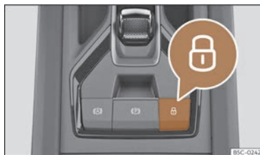
Abb. 78 Auf der Mittelkonsole: Zentralverriegelungstaster
