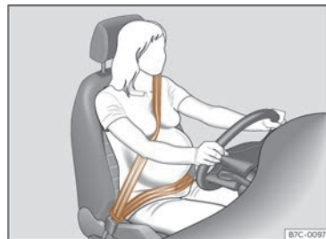
Abb. 25 Gurtbandverlauf bei schwangeren Frauen.
