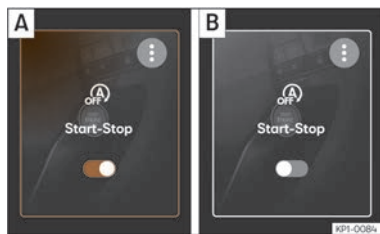
Abb. 123 Im Infotainment-System: Start-Stopp-System (in verschiedenen Menüs des Infotainments verfügbar).
