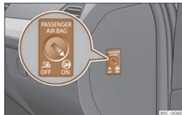
Abb. 28 Schlüsselschalter zum Ein- und Abschalten des Beifahrerairbags.
