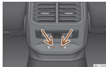
Abb. 174 Mittelkonsole hinten: USB-Anschlüsse mit Steckdosenfunktion.
