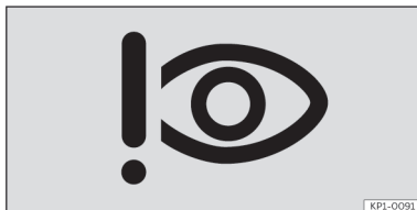
Abb. 8 Am Bildschirm des Kombi-Instruments: Symbol des Aufmerksamkeitsassistenten.
