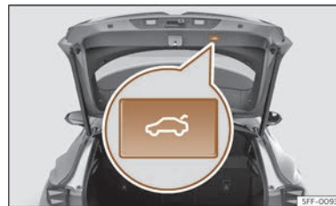
Abb. 83 Heckklappe: Taste zum Schließen der Heckklappe.
