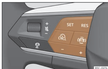
Abb. 137 Am Multifunktionslenkrad: Tasten zur Bedienung des Geschwindigkeitsbegrenzers.
