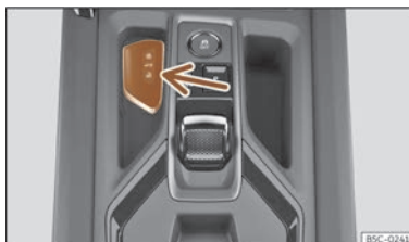
Abb. 71 Mittelkonsole (mit Automatikgetriebe): Aufnahme für den Fahrzeugschlüssel
