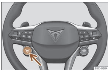
Abb. 127 Multifunktionslenkrad: Schalter für den Fahrprofilwechsel.
