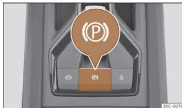
Abb. 155 Im unteren Bereich der Mittelkonsole: Taste für die elektronische Parkbremse.
