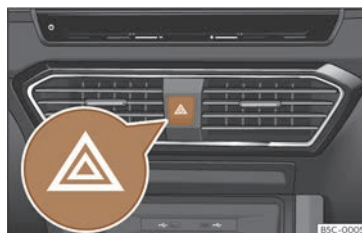
Abb. 50 Instrumententafel: Schalter für die Warnblinkanlage
