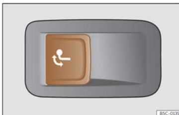
Abb. 199 Auf der linken Seite im Gepäckraum: Taste zur Entriegelung der Anhängerkupplung.
