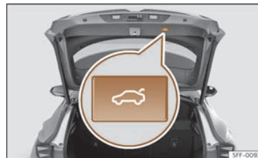
Abb. 84 Heckklappe: Taste zum Schließen der Heckklappe.
