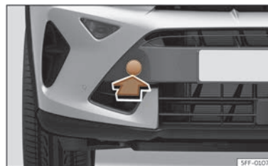
Abb. 213 Auf der rechten Seite des vorderen Stoßfängers: Abdeckung entfernen.
