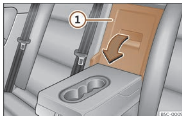
Abb. 195 An der Rücksitzlehne: Öffnung der Durchladeeinrichtung.
