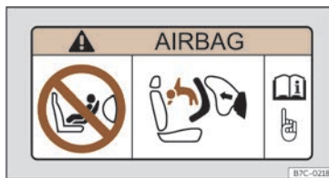
Abb. 38 Airbag-Label: an der Sonnenblende Beifahrerseite.
