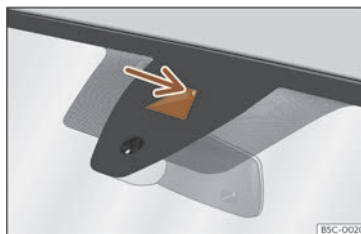
Abb. 133 An der Frontscheibe: Kamerasichtfenster des Spurhalteassistenten.
