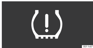
Abb. 245 Kombi-Instrument: Warnung Reifendruckverlust.
