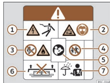
Abb. 56 Warnschild auf der Hochvoltbatterie.
