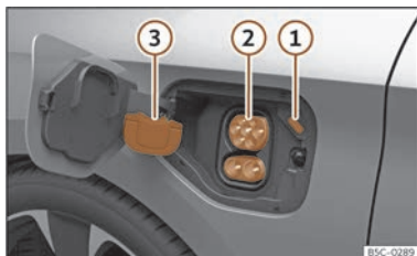
Abb. 63 Hinter der Batterieladeklappe hinten rechts: Ladedose.
