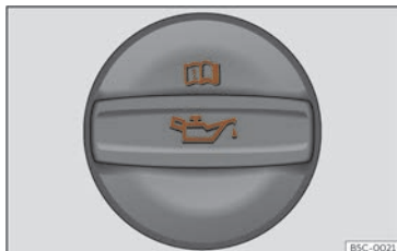
Abb. 231 Deckel der Motoröl-Einfüllöffnung im Motorraum.
