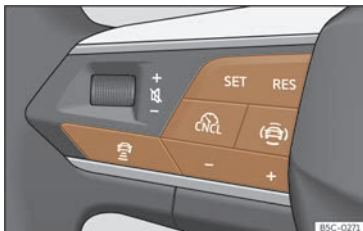
Abb. 141 Am Multifunktionslenkrad: Tasten zur ACC-Bedienung.
