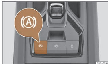
Abb. 156 Im unteren Bereich der Mittelkonsole: Funktionstaste Auto Hold.
