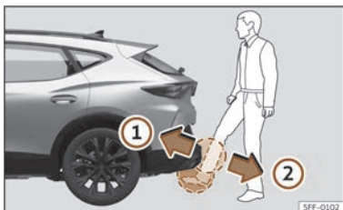
Abb. 86 Heckklappe mit sensorgesteuerter Öffnung (Easy Open).
