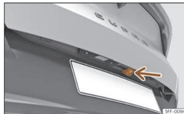
Abb. 136 Im Griff der Heckklappe: Einbauort der Kamera des Rückfahrassistenten.
