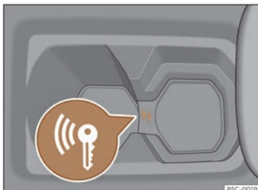
Abb. 122 In der Mittelkonsole: Notstart.
