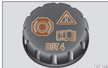
Abb. 225 Frontraum: Deckel des Bremsflüssigkeitsbehälters.
