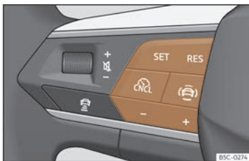
Abb. 137 Am Multifunktionslenkrad: Tasten zur Bedienung der Geschwindigkeitsregelanlage.
