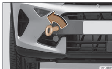
Abb. 214 Vorderer Stoßfänger rechts: Eingeschraubte Abschleppöse
