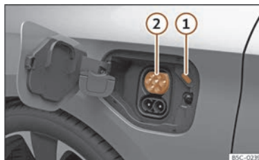
Abb. 60 Hinter der Batterieladeklappe vorn links: Ladedose
