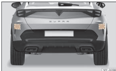
Abb. 134 Bereich hinter dem Fahrzeug: Bereiche der Radarsensoren.
