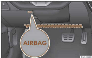
Abb. 35 Auf der Fahrerseite: Einbaubereich des Knieairbags.
