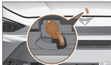
Abb. 221 Hebel unter der Motorraumklappe.
