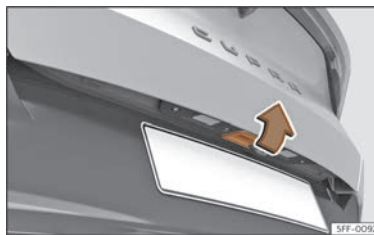
Abb. 83 Heckklappe: Öffnen von außen
