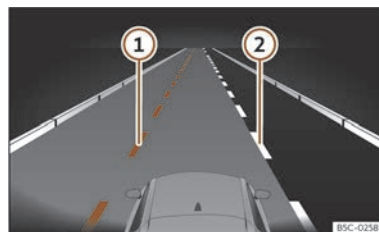
Abb. 147 Im Display des Kombi-Instruments: Anzeige des Spurhalteassistenten.
