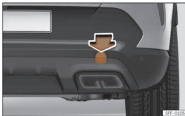
Abb. 215 Auf der rechten Seite des hinteren Stoßfängers: Abdeckung entfernen.
