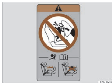
Abb. 39 Airbag-Label: am hinteren Rahmen der Beifahrertür.
