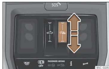
Abb. 92 Im Dachhimmel: Sonnenschutzrollo bedienen.
