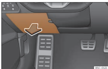
Abb. 217 Auf der Fahrerseite in der Instrumententafel: Abdeckung des Sicherungskastens.
