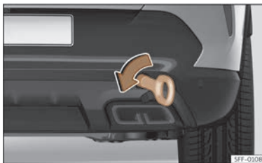
Abb. 216 Auf der rechten Seite des hinteren Stoßfängers: Eingeschraubte Abschleppöse.
