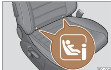
Abb. 41 Beifahrersitz: Einbauort der Halteösen i-Size.
