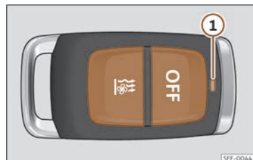
Abb. 120 Standheizung: mit Funkfernbedienung
