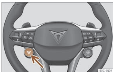
Abb. 96 Multifunktionslenkrad: Schalter für den Fahrprofilwechsel.
