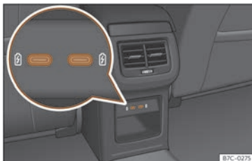
Abb. 154 Mittelkonsole hinten: USB-Anschlüsse mit Steckdosenfunktion.
