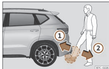
Abb. 56 Heckklappe mit sensorgesteuerter Öffnung (Easy Open).
