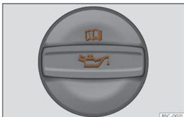
Abb. 206 Deckel der Motoröl-Einfüllöffnung im Motorraum.
