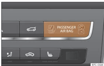
Abb. 25 Instrumententafel: Kontrollleuchte für abgeschalteten Beifahrerairbag.
