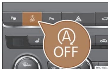
Abb. 90 Mittelkonsole: Systemtaste Start-Stopp.
