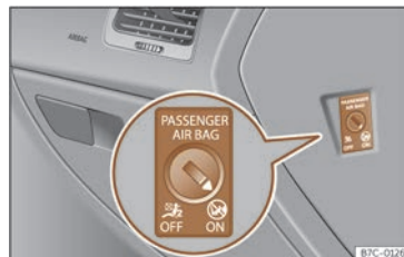
Abb. 24 Schlüsselschalter zum Ein- und Abschalten des Beifahrerairbags.
