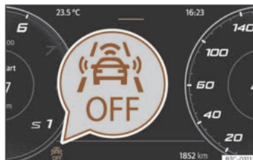
Abb. 118 Auf dem Display des Kombi-Instruments: Anzeige, dass Front Assist ausgeschaltet ist.
