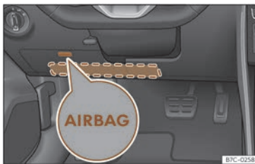
Abb. 29 Auf der Fahrerseite: Einbauort des Knieairbags.
