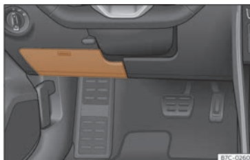
Abb. 193 Auf der Fahrerseite in der Instrumententafel: Abdeckung des Sicherungskastens.
