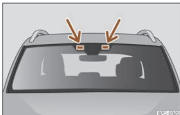
Abb. 87 Bereiche für das Anbringen elektronischen Zubehörs.
