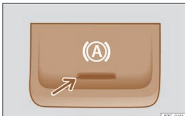
Abb. 127 Im unteren Bereich der Mittelkonsole: Funktionstaste Auto Hold.
