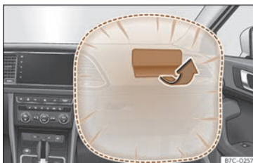
Abb. 23 Beifahrerairbag in der Instrumententafel
