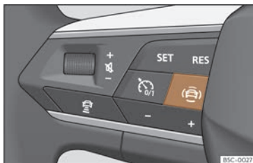
Abb. 99 Linke Seite des Multifunktionslenkrads: Taste für die Fahrerassistenzsysteme (modellabhängig).
