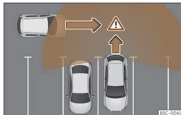
Abb. 146 Schematische Abbildung des Ausparkassistenten: Überwachter Bereich des ausparkenden Fahrzeugs.
