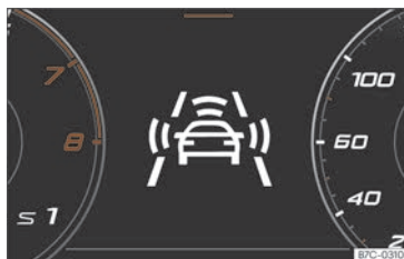
Abb. 116 Im Display des Kombi-Instruments: Vorwarnhinweise.
