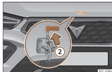
Abb. 198 Hebel unter der Motorraumklappe.
