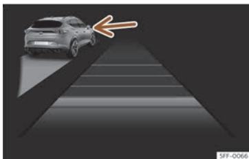
Abb. 111 Am Bildschirm des Kombi-Instruments: ACC aktiv, Fahrzeug auf der linken Seite erkannt.
