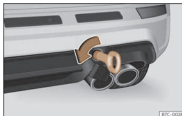
Abb. 192 Auf der rechten Seite des hinteren Stoßfängers: Eingeschraubte Abschleppöse.
