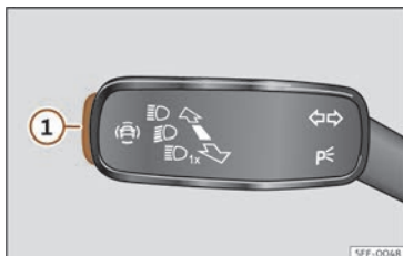
Abb. 98 Am Blinker- und Fernlichthebel: Taste für die Fahrerassistenzsysteme (modellabhängig).
