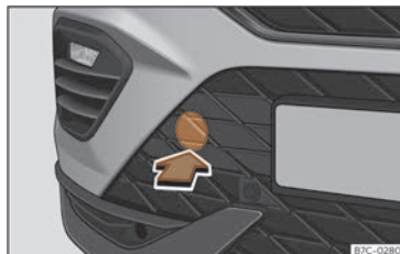
Abb. 189 Auf der rechten Seite des vorderen Stoßfängers: Abdeckung entfernen.
