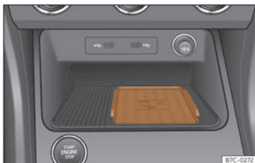
Abb. 160 In der Mittelkonsole: Aufnahme für die Mobiltelefonkopplung.
