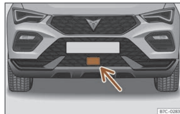
Abb. 100 Im vorderen Stoßfänger: Radarsensor.
