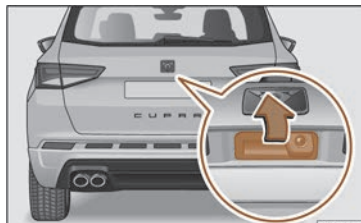
Abb. 53 Heckklappe: Öffnen von außen
