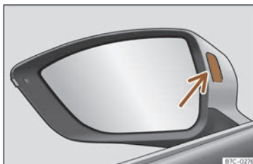
Abb. 122 Kontrollleuchte des Spurwechselassistenten.
