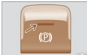
Abb. 126 Im unteren Bereich der Mittelkonsole: Taste für die elektronische Parkbremse.
