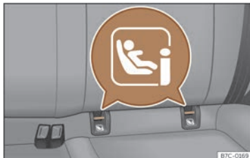
Abb. 34 Rücksitz: Einbauort der Halteösen ISOFIX oder i-Size.
