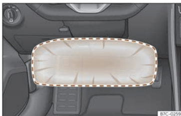
Abb. 30 Auf der Fahrerseite: Wirkungsbereich des Knieairbags.
