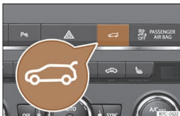
Abb. 55 Mittelkonsole: Taste zum Öffnen und Schließen der Heckklappe.
