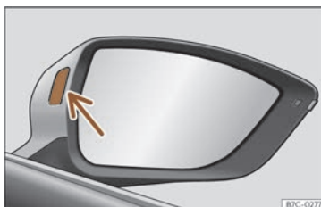
Abb. 123 Kontrollleuchte des Spurwechselassistenten.
