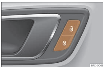
Abb. 48 An der Fahrertür: Zentralverriegelungstaster.
