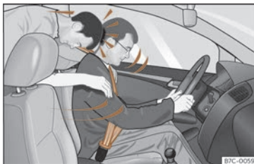
Abb. 17 Der nicht angeschnallte Mitfahrer auf dem Rücksitz wird nach vorn auf den angeschnallten Fahrer geschleudert.
