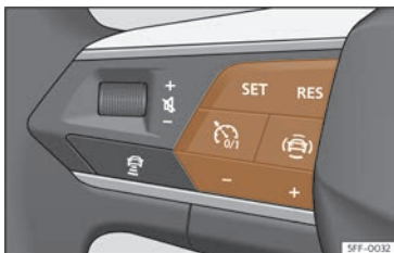
Abb. 106 Am Multifunktionslenkrad: Tasten zur Bedienung der Geschwindigkeitsregelanlage.
