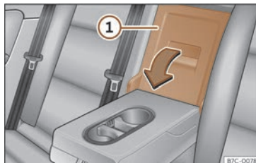
Abb. 172 An der Rücksitzlehne: Öffnung der Durchladeeinrichtung.
