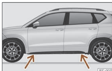
Abb. 216 Aufnahmepunkte für den Wagenheber.
