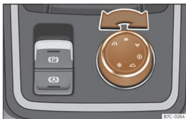
Abb. 95 Mittelkonsole: Drehschalter (Driving Experience button).
