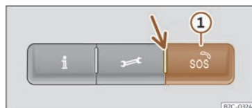
Abb. 40 In der Dachkonsole: Schalter für Sprachdienste
