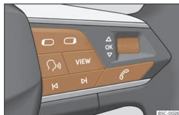
Abb. 7 Rechte Seite des Multifunktionslenkrads: Bedienelemente für die Menüs und Informationsanzeigen im Kombi-Instrument (modellabhängig).
