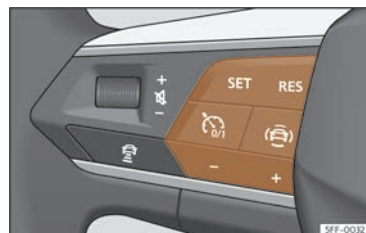
Abb. 107 Am Multifunktionslenkrad: Tasten zur Bedienung des Geschwindigkeitsbegrenzers.
