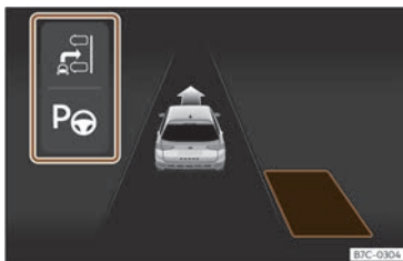
Abb. 134 Am Bildschirm des Kombi-Instruments: Anzeige des Parklenkassistenten mit eingeschränkter Sicht.
